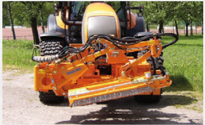
Randstreifenmähergerät MRS 300 in Transportstellung
