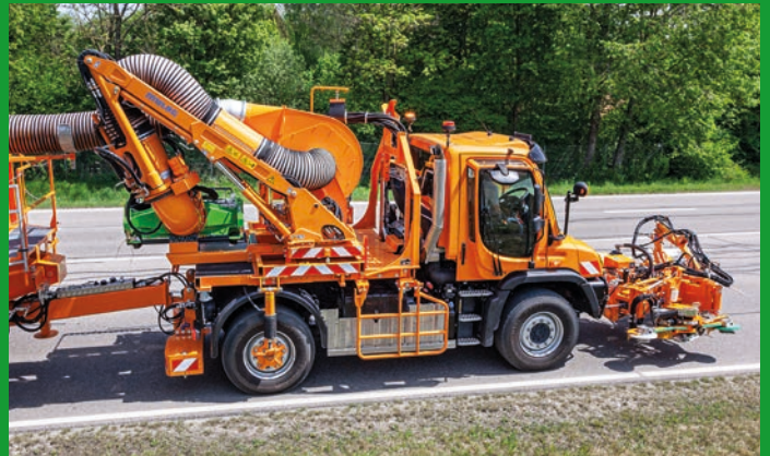
Position de transport SB 600 avec tête d'entretien des espaces verts ECO 1200 plus
