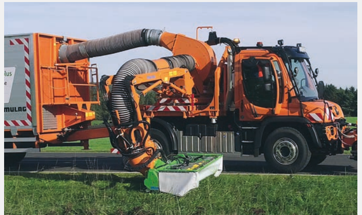
Flèche arrière SB 600 avec tête d'entretien des espaces verts ECO 1200 plus montée
