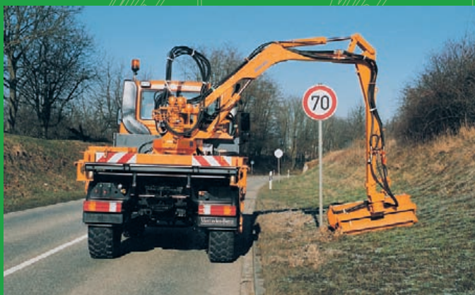
Große Portalhöhe durch optimierte Auslegergeometrie
